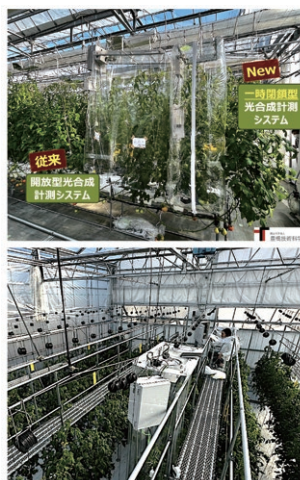
光合成計測チャンバ(上)とセミクローズド温室への設置状況(下)と内観(制御室)(下)
