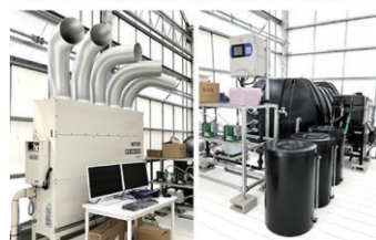
光合成計測チャンバ(上)とセミクローズド温室への設置状況(下)と内観(制御室)(下)
