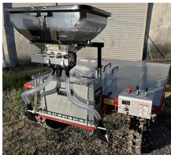
図1. 自動施肥制御技術を搭載した作業車
