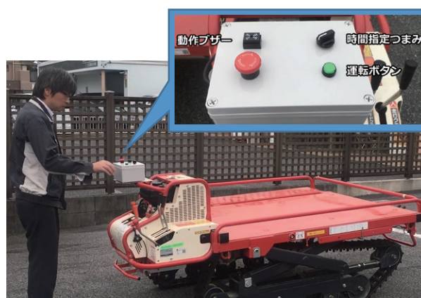
図2. 間欠移動機能を搭載した作業車
