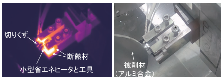
図1 開発した省エネ加熱切削の様子(左：サーモグラフィ写真、右：通常写真)
