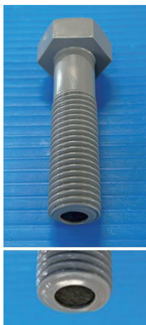
rCF の応用先として考案した 芯鞘マルチ構造ボルト
