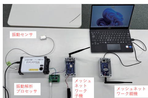
開発した振動監視システム (子機1台と親機1台の外観)
