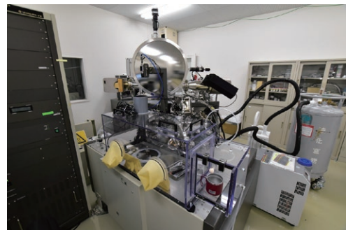
当該研究で実装された低温試料導入用グローブボックス、低損傷エッチング装置、および低温ステージを兼ね備えた二次イオン質量分析装置の外観
