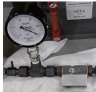
図2 3D 造形部品に対する油圧試験の様子
