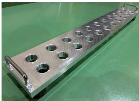
図1 造形に成功した大型（1m 以上）の中空構造ジグモデル
