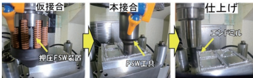
図3 押圧 FSW 装置によるクランプレス造形の様子
