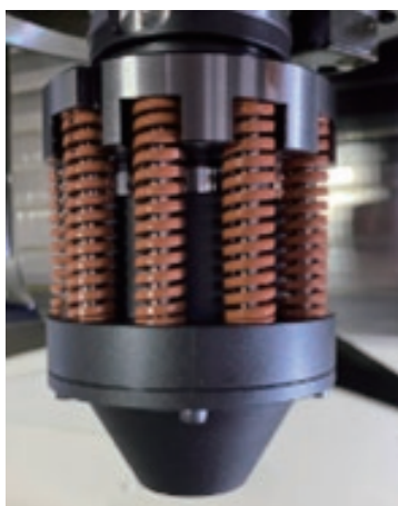
図2 従来のクランプ機構を排除する 押圧 FSW 装置
