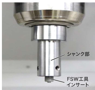
図1 鋼の積層造形を実現した高耐熱セラミック製FSW工具
