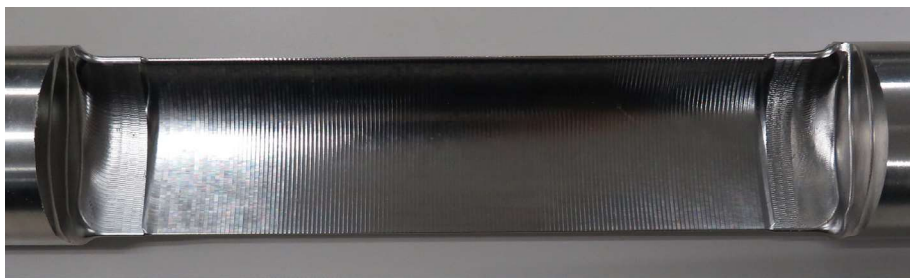
図2 開発技術で試作したTiAl製タービンブレード
