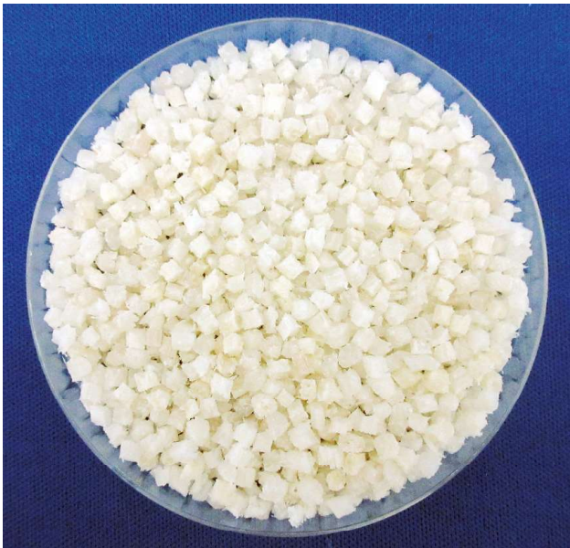
射出成形用コンパウンド(ナノシリカ中空粒子:10mass%)
