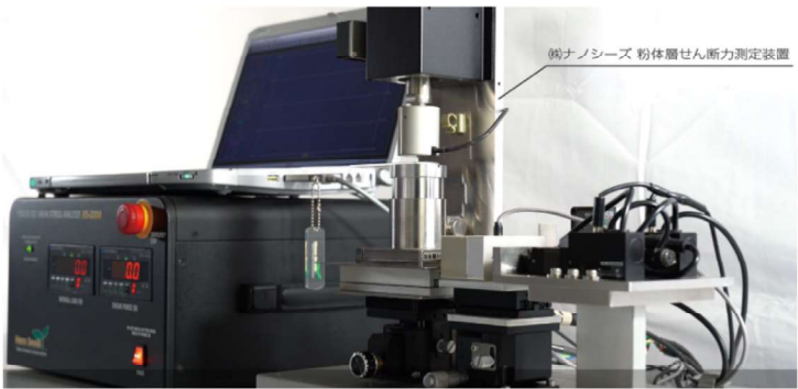
粉体層せん断力測定装置から取得できる粉体物性パラメータ 粉体動摩擦角、応力伝達率、応力緩和率、圧縮率、かさ密度 内部摩擦角、せん断付着力、フローファクターなど
