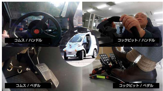
遠隔運転実証実験風景
