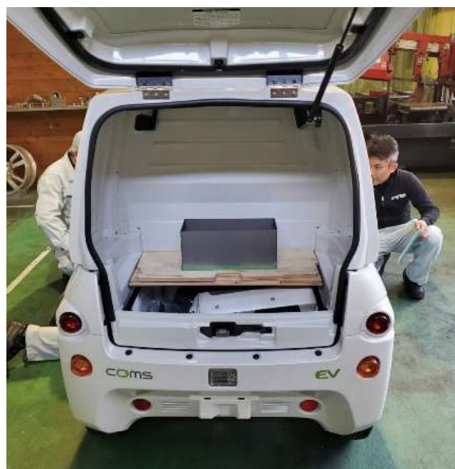
超小型EVコムスに搭載した熱バッテリー
