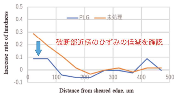
図3 超硬パンチのPLGの鋭利化によるひずみ低減効果
