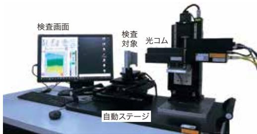
図1 非接触自動計測装置の概観
