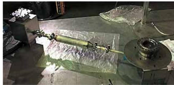
メタン直接分解水素製造装置
