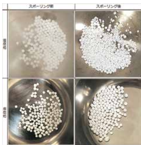
熱衝撃試験後担体粒子外観
