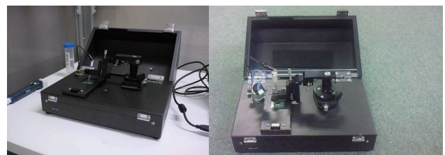
創薬研究用センサデバイスは、専用装置によりバッチ方式で計測される。
