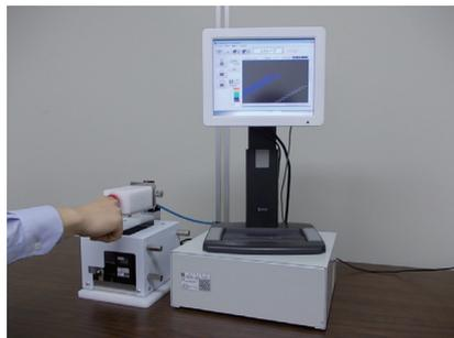
図3 指先型PMC計測装置。指先に陰圧を負荷し、その後の血管径の変化を計測する。こうして血管平滑筋の収縮能の亢進状態を見積もることができ、喫煙者の突然死に繋がる冠攣縮の発生リスクの高さの評価や生活習慣病における狭心症のリスク評価に活用できる。
