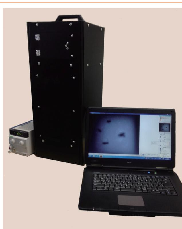
図1 卓上型NIRイメージング異物検査装置
