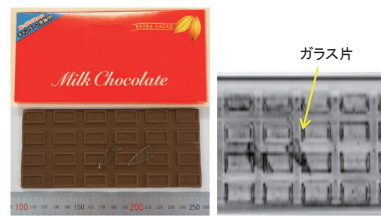
紙ケースに入ったチョコレートとガラス片の写真とそのTHz画像
