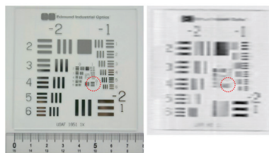
テストパターンの写真(左)とそのTHz画像(右)
