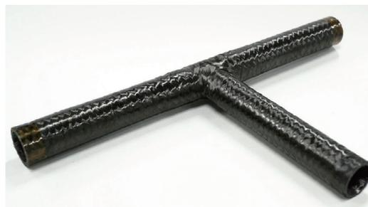
テープラッピング後、オープンで樹脂を硬化させることにより、FRPパイプの成形が完了する。
