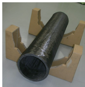
図2.3 RTM実施後の状況
