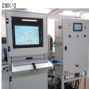
写真. VaRTM樹脂注入装置.
