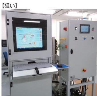
写真. VaRTM樹脂注入装置.
