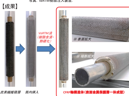
写真. VaRTM法によるCFRP軸構造体の作製.
