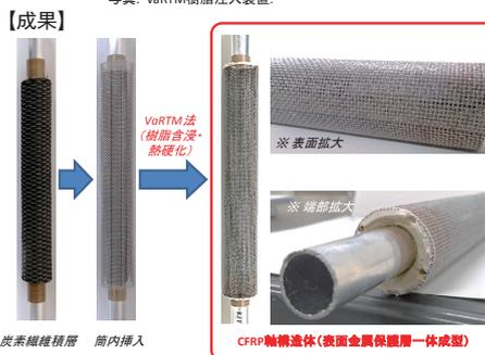
写真. VaRTM法によるCFRP軸構造体の作製.
