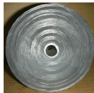
写真. 肉厚CFRP軸構造体の断面写真(直径:約100mm).
