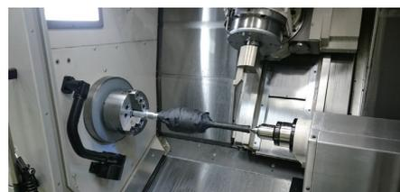
図 高弾性率CFRPの切削
