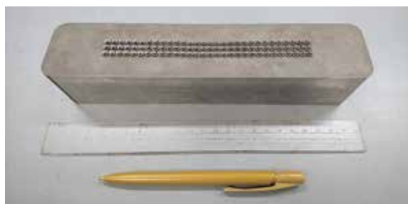
積層造形で製作したチタン合金製10kW水素マイクロレイバーナー
