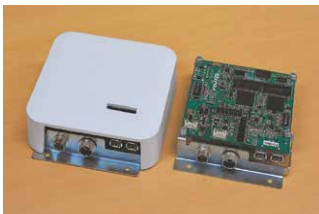
コンパクトな安全関連センサ ケース入り外観(左)と内部実装基板
