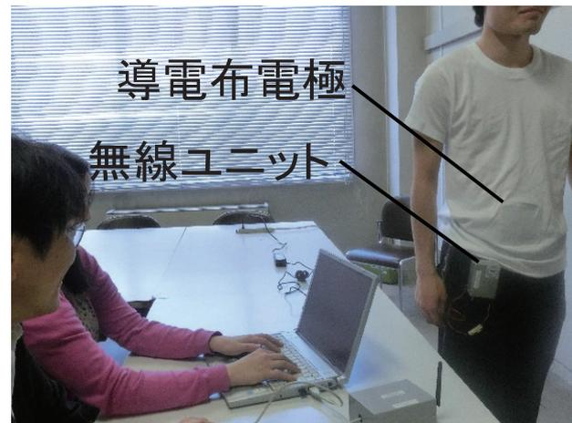
Tシャツ内側に導電布電極を配置した呼吸センサと無線ユニットの例
