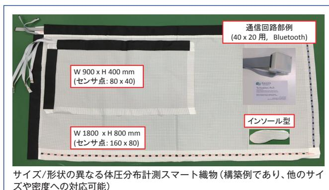
サイズ/形状の異なる体圧分布計測スマート織物 (構築例であり、他のサイズや密度への対応可能)
