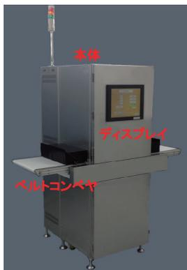
食品製造ライン導入型のNIRイメージング異物検査装置。ベルトコンベヤにて食品を検査部へ導入し検査後排出する機能を有しており、NIRは食品の表と裏側から照射され、透過光像にて異物検出がなされる。
