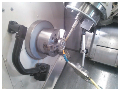
ロータリターニングによるタービンディスクモデルの加工試験の様子。複合加工機を用いて実施。
