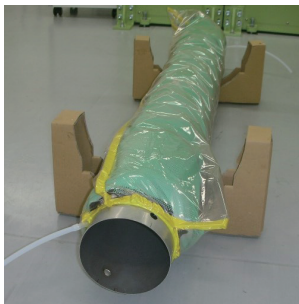
図2.2 RTM前のシール
