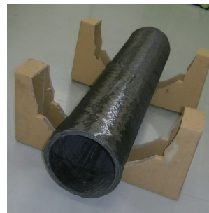
図2.3 RTM実施後の状況
